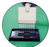
SpectraDrop 사용 시 Microvolume 측정 가능 (별도 구매, 18 page)
